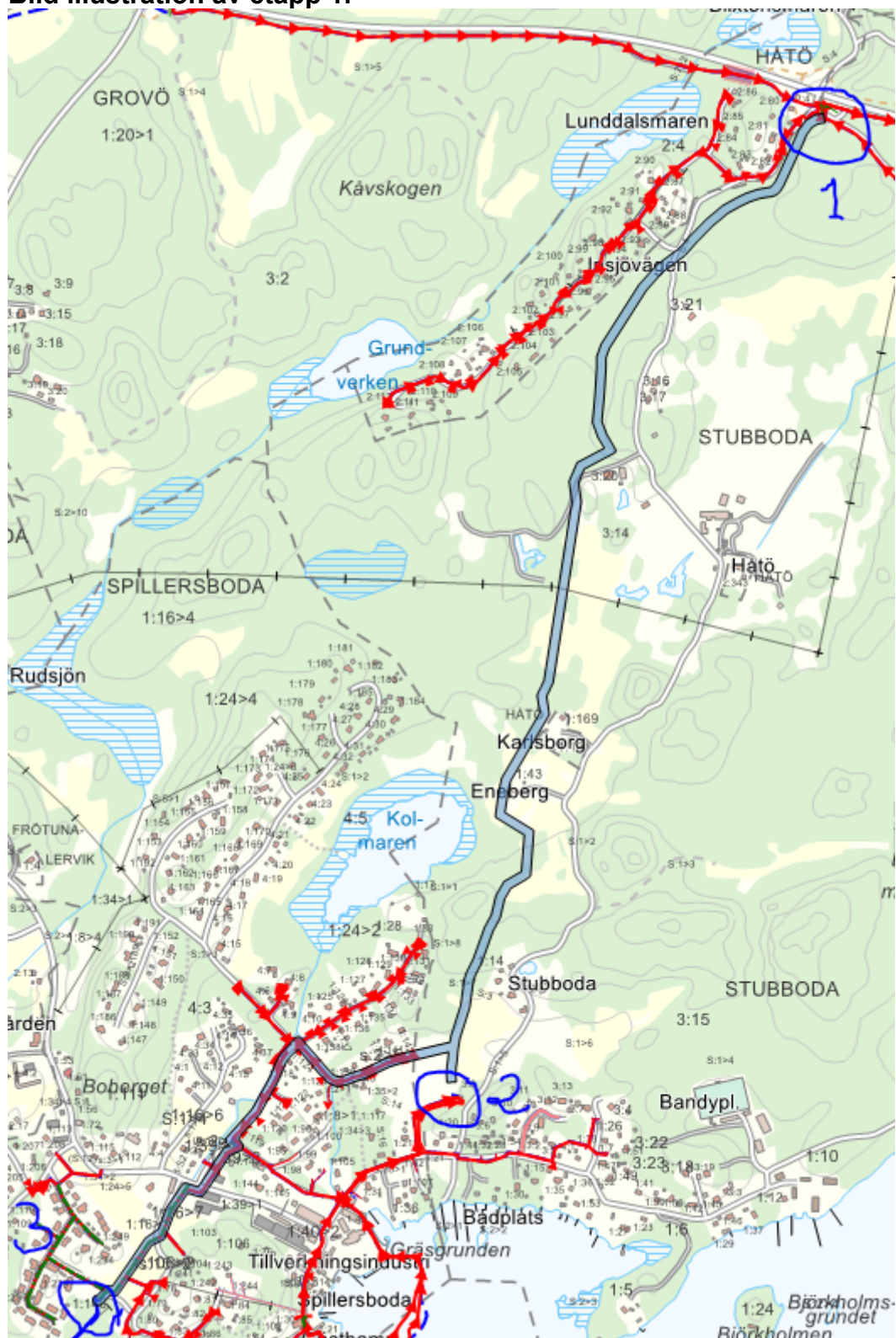
Bild 1 Ledningssträcka 1-2 (Hätö - Spillersboda ARV) Spill och vatten byggs först, därefter ledningssträcka 2-3 (Spillersboda ARV-Tryckstegringsstationen) vatten till tryckstegringsstationen.
