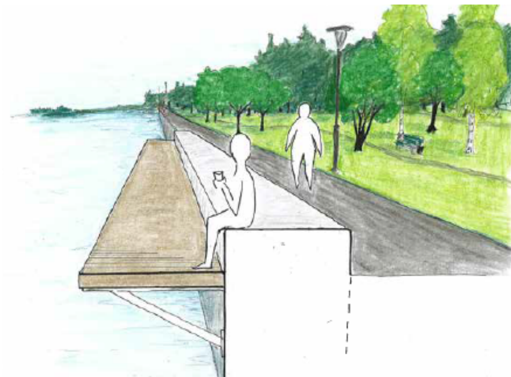
Se illustration ovan över sektion med ny kajbalk med brygga
