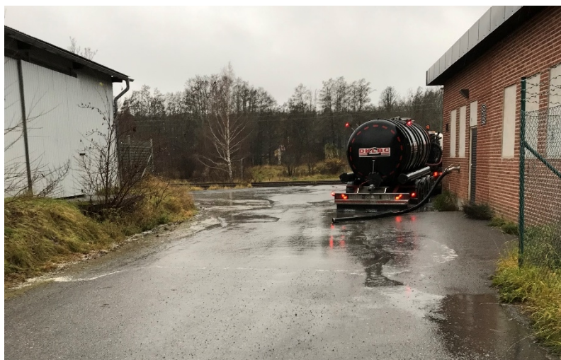
Figur 1: Incident där slangen från sugbil lossnat vid tömning av septikslam
