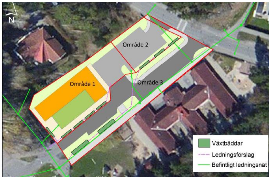
Skiss på förslag på dagvattenlösning för fastigheterna Karljohansvampen 1 och del av Tälje (Dagvattenutredning för Karljohansvampen 1 och del av fastigheten Tälje 3:1, 2018-05-08). Källa: Geosigma.
