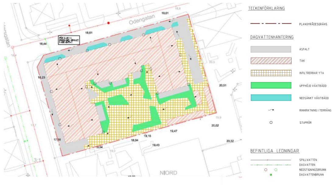
Dagvattenlösningar, förslagskiss. Källa: ÅF Infrastructure AB
