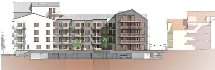
Illustration av fasader/sektioner mot söder och gården. Visar även delvis garage, ramp och intilliggande bebyggelse. Källa: Arkipol AB.
