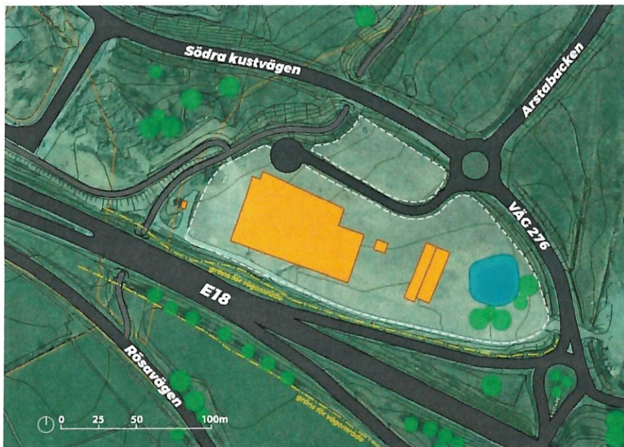
Figur 17. Alternativ 1C. Detta alternativ innebär en ny cirkulationsplats med en vägsträckning som enbart angör östra sidan. Vägdragning och läge är flexibla. En vändplan krävs. Fastigheten behöver inte delas upp i och med vägdragningen.
