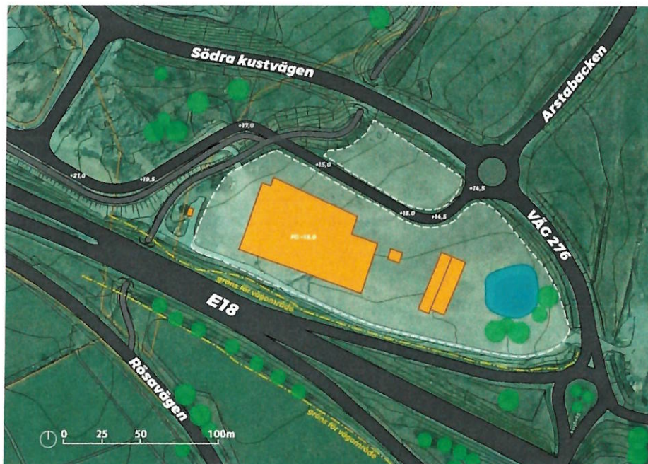
Figur 15. Alternativ 1A. Detta alternativ innebär att en ny cirkulationsplats mot Södra Kustvägen skapas och att bilvägen kopplar vidare västerut via en ny väg i samma sträckning som gångvägen. Roslagsleden korsas i plan. Fastigheten delas upp.
