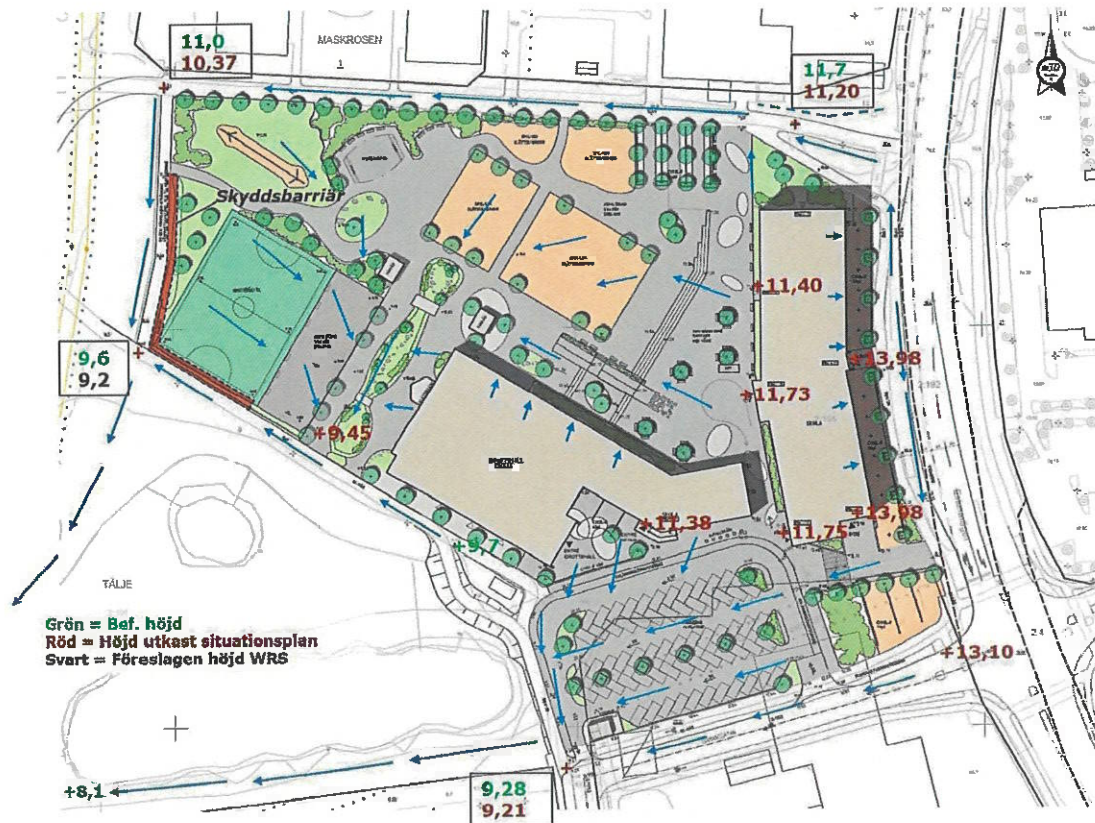
Figur 3. Förslag till sekundära avrinningsvägar för att hantera skyfall från planområdet samt från mark utanför området. Alternativ för idrottshall i söder. Bakgrundsbild: Utkast till situationsplan, erhållen 2021-05-17 (m3D, 2021b).
