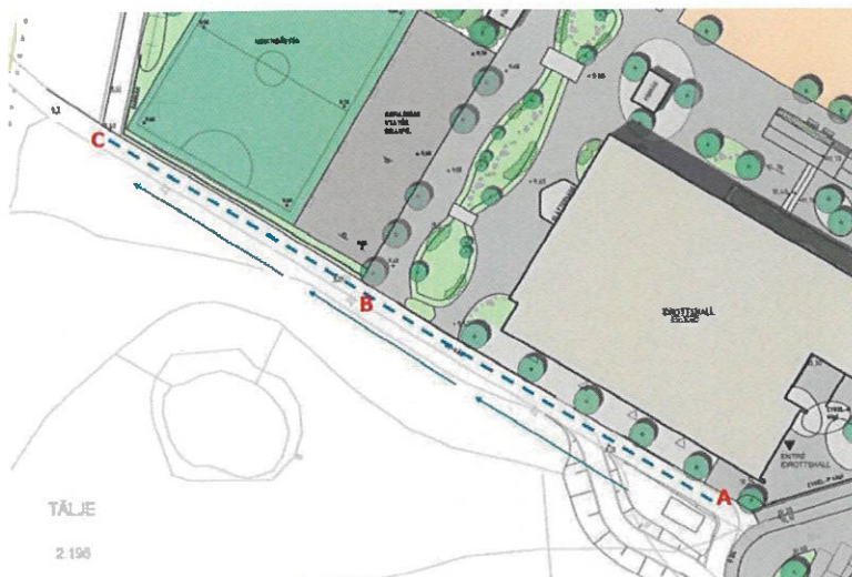
Figur 4. Illustration över befintlig GC-väg (sträckad linje) som föreslås justeras för att hantera skyfall från skolområdet. Blå pilar visar flödesriktning. Bakgrundsbild: Utkast till situationsplan, erhållen 2021-05-17 (m3D, 2021b).
