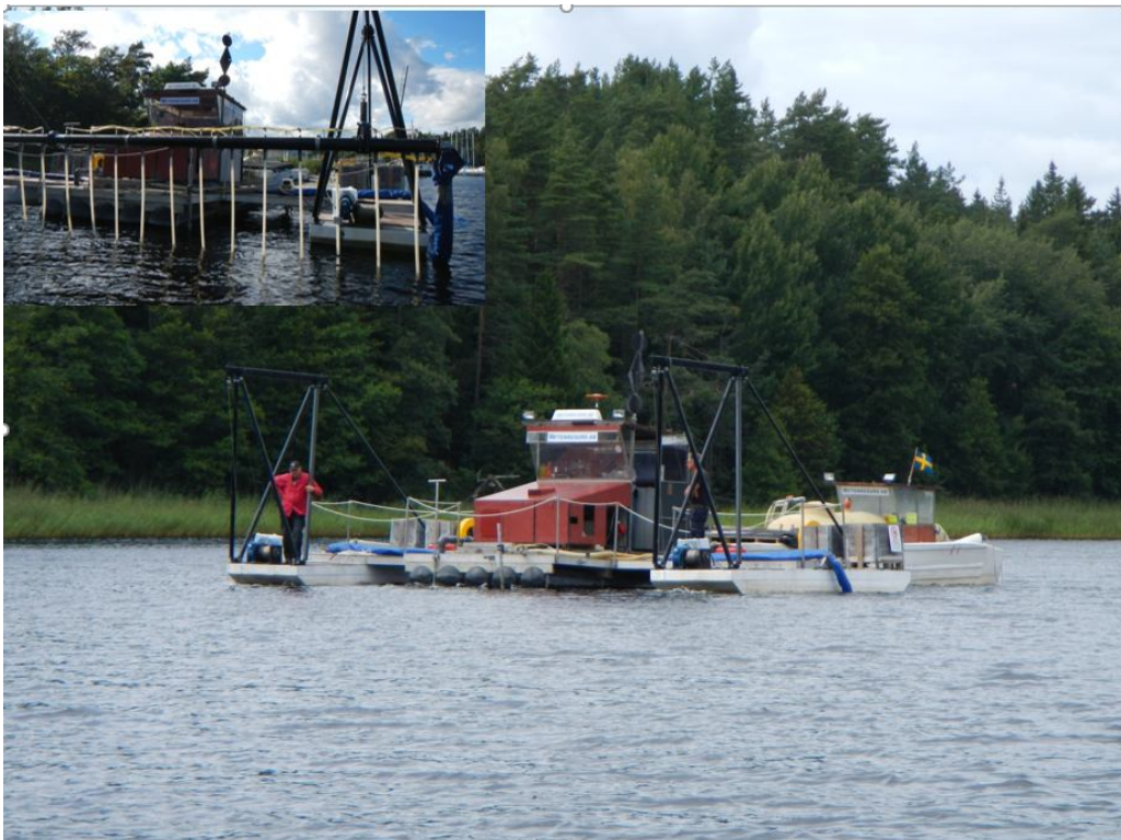
Bild 3. Sedimentinjicering av aluminium (bild av Emil Rydin Naturvatten i Roslagen AB)
