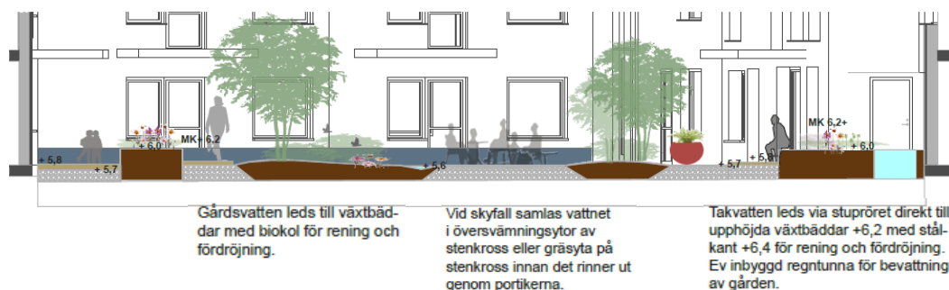
Sektion över innergården med föreslagen dagvattenhantering. Veronika Borg landskapsarkitektur & stadsbyggnad.
