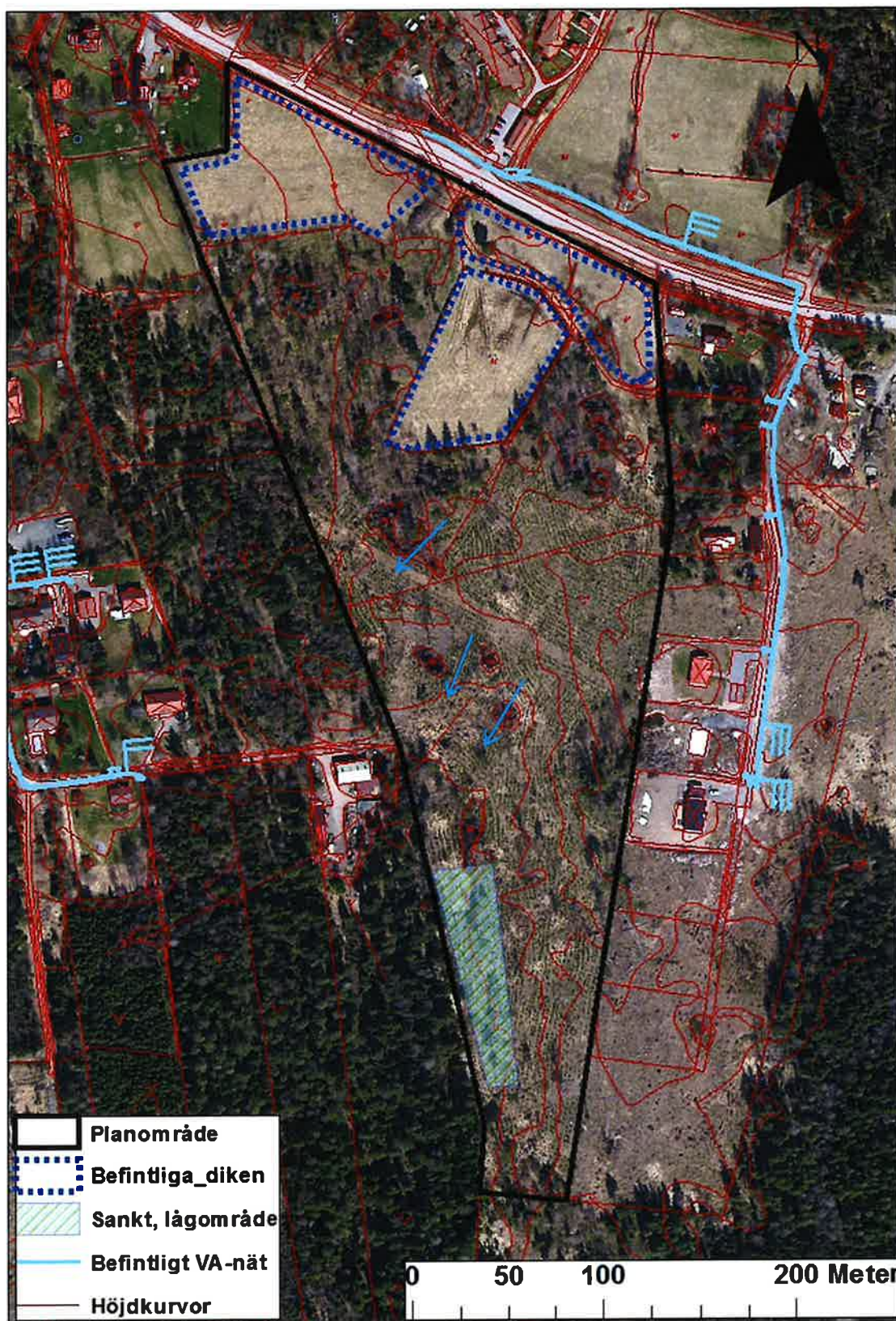
Figur 3-3. Ritning över planområdet (svart polygon), höjdkurvor och fastighetsgränser (röda linjer), samt befintliga VA-ledningar och diken (ljusblåa linjer och blåa punktade linjer). Blå pilar visar antagna flödesriktningar.
