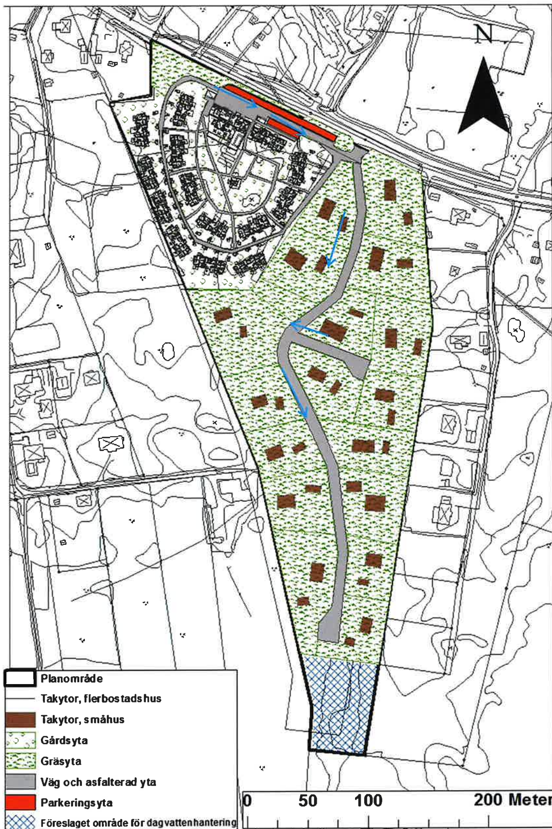
Figur 5-1. Principskiss över dagvattenhanteringen för Gräddö 2:41 – 2:43. Fördröjningsmagasinet kan placeras inom de blåstreckade ytorna. Avrinnande vatten från tak, vägar, parkering och garageuppfarter leds i vägbanan, i diken eller i underjordiska ledningar.
