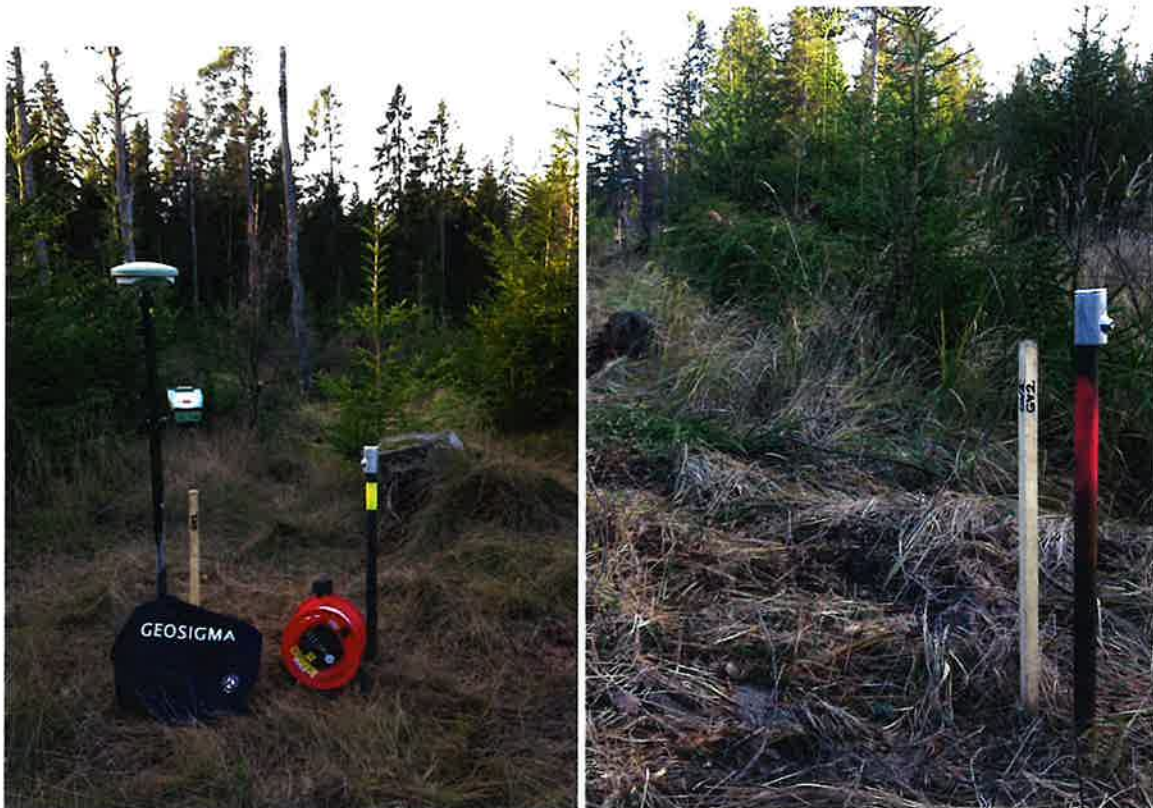
Figur 7-4. Fotografier på grundvattenrör GV1 och GV2. Uppe till vänster i det högra fotografiet skimtar GV1 som ligger högre upp i terrängen än GV2.
