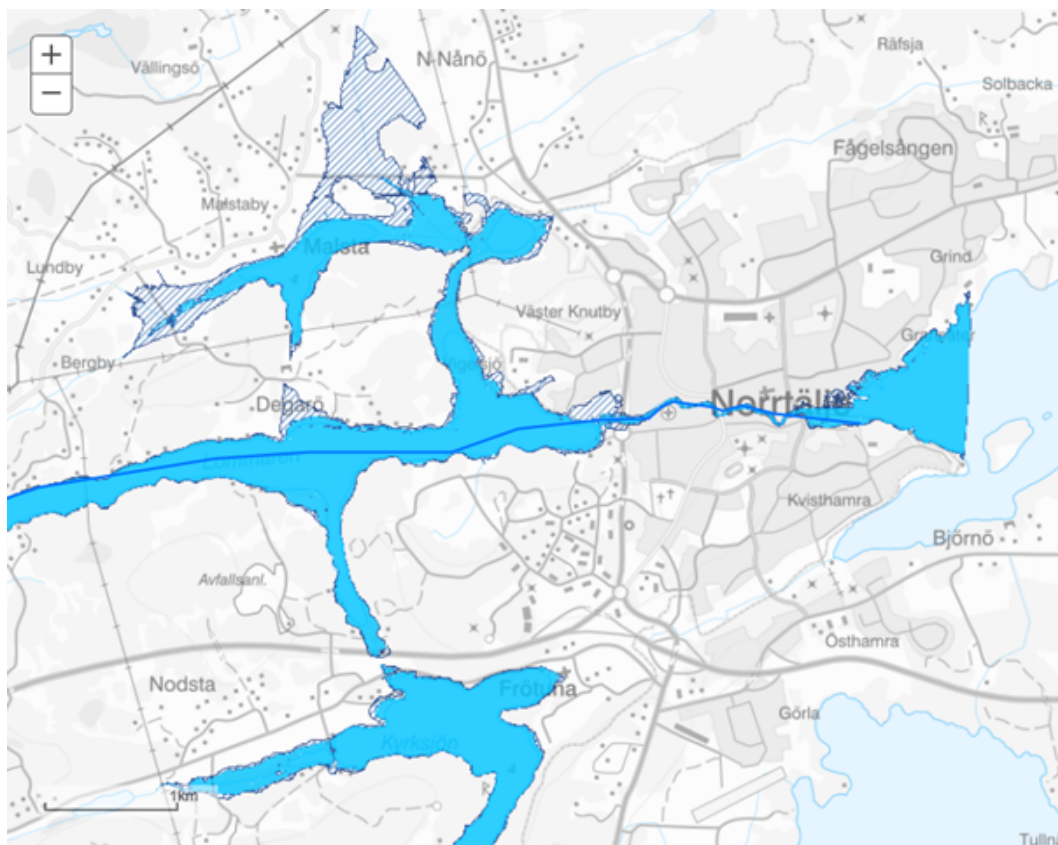
Figur 12 Utsträckning av 100- och 200-årsflöden (helfärgat respektive streckat) för översvämning kring Norrtälje centrum.
