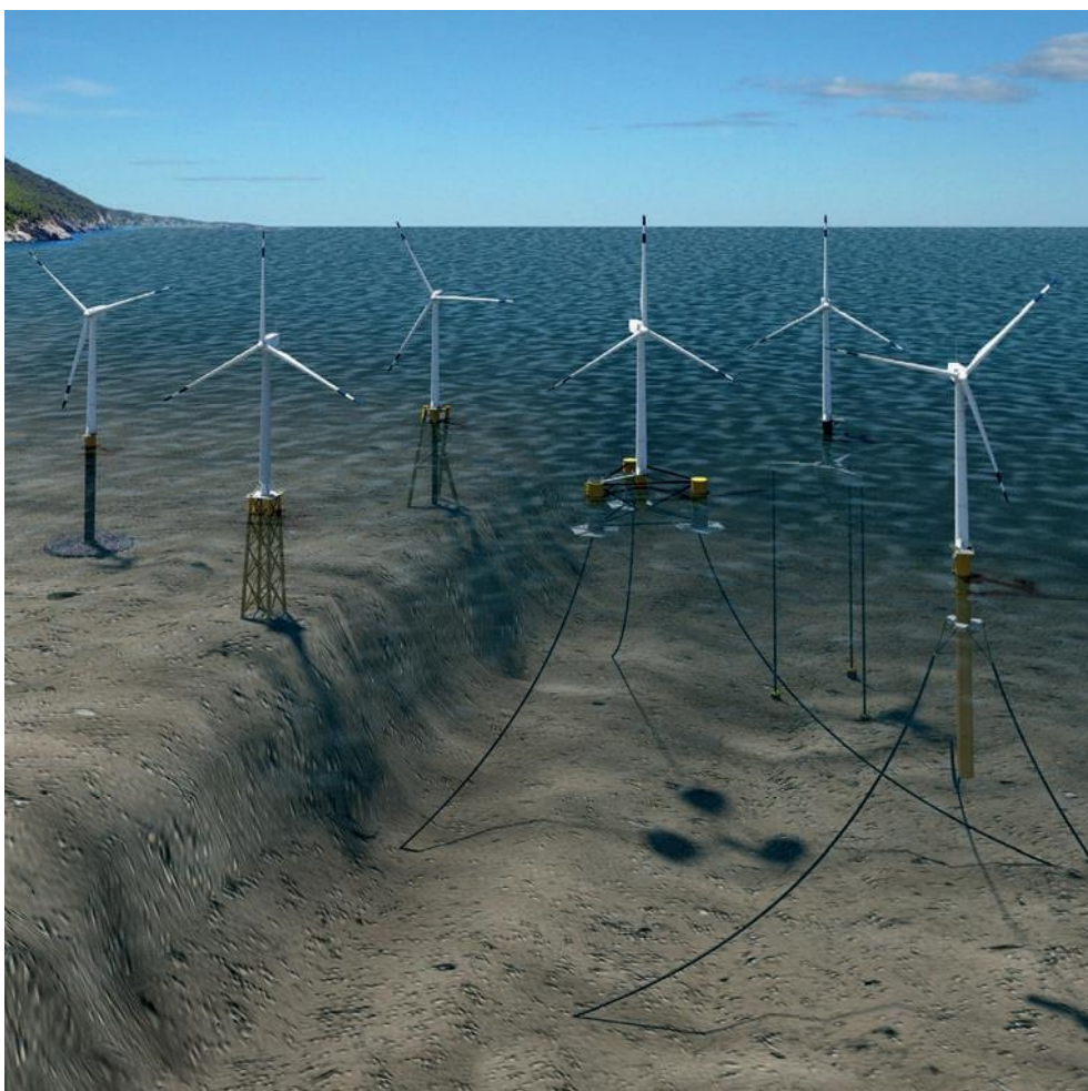
FIGUR 20 Översikt av fundamenttyper för havsbaserade vindkraftverk. Källa: Illustration Joshua Bauer, NREL 49055.
