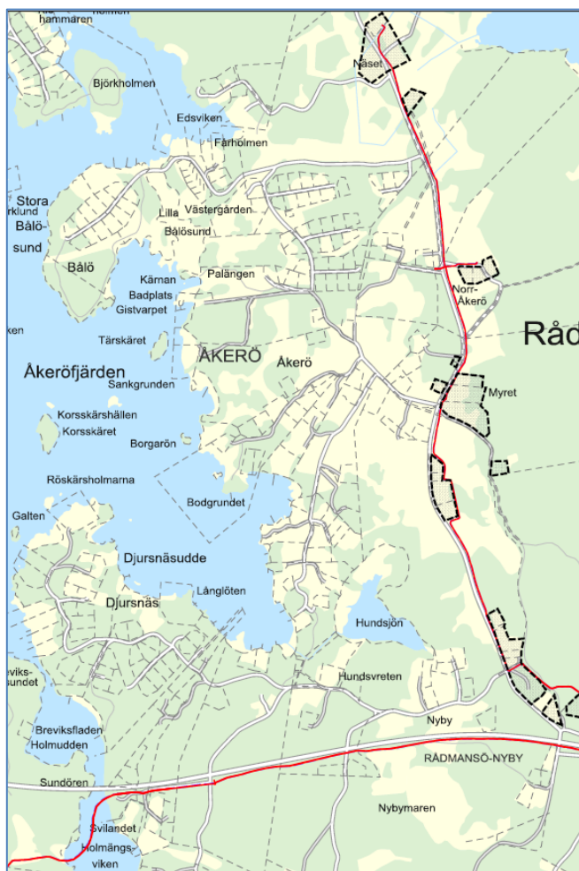
Figur 6. Åkerö. Inom detta område återfinns de fastigheter bygg- och miljönämnden inventerat. Utbyggnadsprojektets omfattning kommer att utredas i samband med projektstart. Befintligt och utbyggt VA-verksamhetsområde längs den rödmarkerade överföringsledningen längs Åkerövägen markerat med svart.
