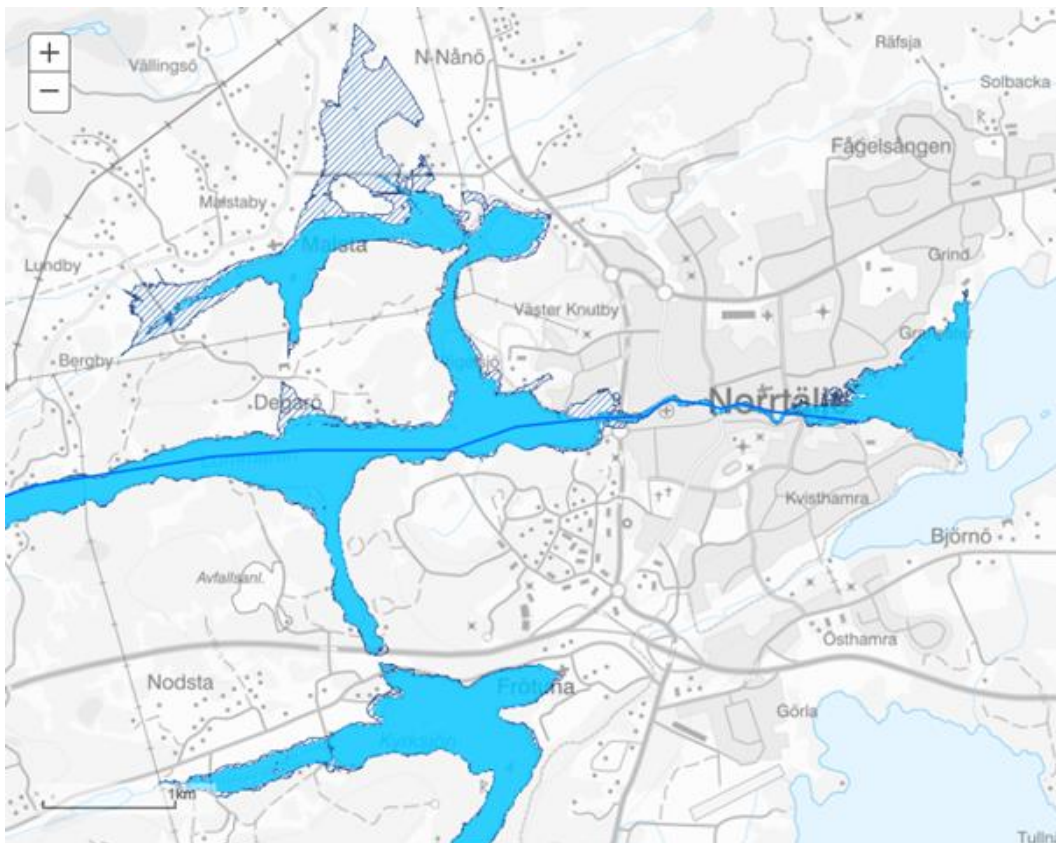
Figur 12 Utsträckning av 100- och 200-årsflöden (halfärgat respektive streckat) för översvämning kring Norrtälje centrum.
