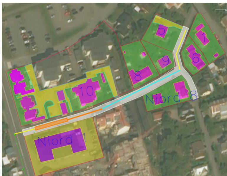
Figur 3: I figuren framgår den dagvattenanläggning och de anslutande fastigheter som planeras i Odengatan/Torsgatan inom ramen för detta investeringsärende.
