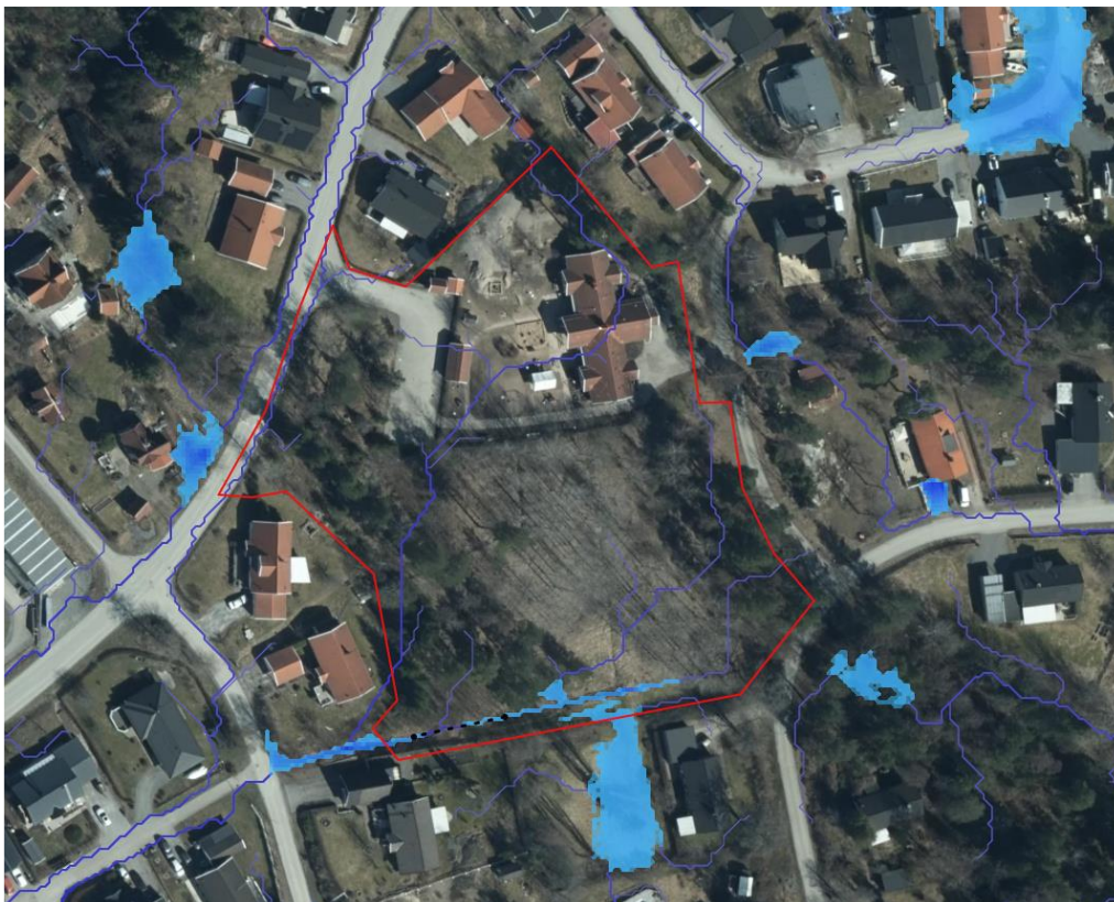
Skyfallsscenario vid befintlig situation, 10 cm nederbörd
