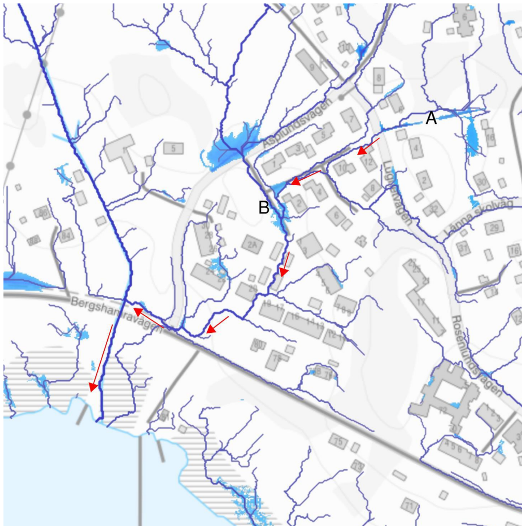
Flödesväg för ytligt avrinnande skyfallsvatten från planområdet till recipienten (Structor, 2024-07-03).
